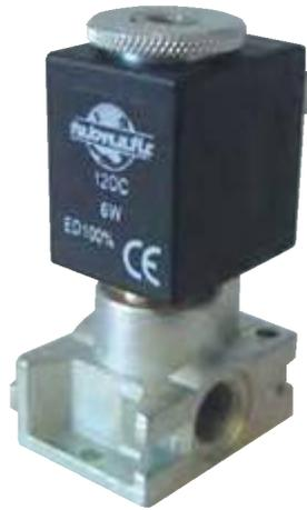
Les mini-électrovannes à commande directe de la série EP sont disponibles dans les versions 3/2 (transformables en 2/2) normalement ouvertes et fermées. Leur embase modulaire peut être utilisée soit en mode simple, soit en batterie par la fracture de la paroi lenticulaire servant à l'alimentation. Chaque électrovanne est livrée avec un joint OR et une vis pour le montage en batterie.
